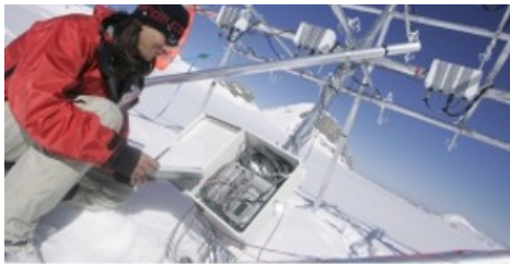
Ein Forscher der ETH Lausanne installiert Schall-Windmesser auf dem Gletscher der Plaine Morte. Damit lassen sich die Luftturbulenzen über der Schneedecke mit sehr grosser räumlicher und zeitlicher Auflösung messen. Foto: Jacques Martinet © Schweizerischer Nationalfonds, Presse- und Informationsdienst, Bern. Reproduktionsgebühr mit Quellenangabe: "Schweizerischer Nationalfonds"
