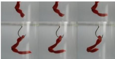
*Bildlegende: Wenn das Polymer ins Wasser getaucht wird, lösen sich die chemischen Bindungen zwischen den Nanofasern aus kristalliner Zellulose und das Polymer findet zu seiner ursprünglichen Geometrie zurück. © Institut Adolphe Merkle/SNF*
