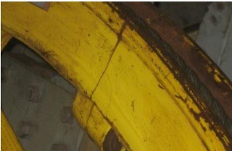
*Schilthornbahn - Schadenbehebung verläuft planmässig, Umlenkrad mit Ermüdungsriss / Weiterer Text ueber ots und auf <http://www.presseportal.ch>. Die Verwendung dieses Bildes ist fuer redaktionelle Zwecke honorarfrei. Veröffentlichung unter Quellenangabe: "ots.Bild/Schilthornbahn AG".*
