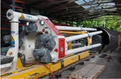
*Nagra, FE-Experiment, Experiment FE, Full Scale Emplacement Demonstration, die eigens entwickelte Verfüllmaschine im Vortest in einer Lagerhalle. Weiterer Text über OTS und [www.presseportal.ch/pm/100004441](http://www.presseportal.ch/pm/100004441) / Die Verwendung dieses Bildes ist für redaktionelle Zwecke honorarfrei. Veröffentlichung bitte unter Quellenangabe: "obs/Nagra/Comet Photoshopping"*
