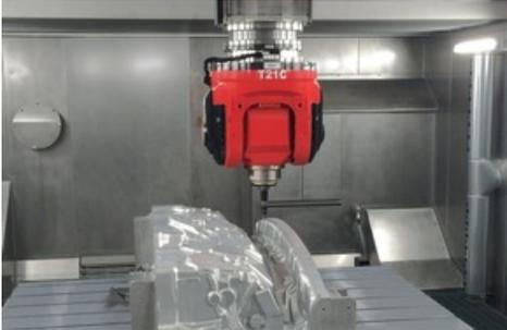
*Fräsen einer Aluminiumgussform für die Fertigung von Stirnwandisolationen. Weiterer Text über
