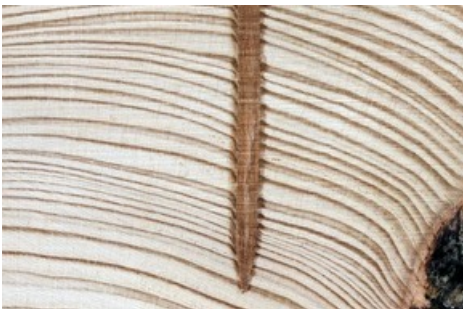
BILD zu OTS - BECK LignoLoc® verbindet sich stoffschlüssig mit dem Umgebungsholz. Quelle: BECK Fastener Group
