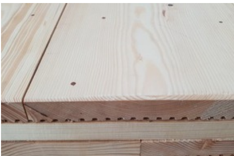
BILD zu OTS - LignoLoc® in der Vollholzwandproduktion: keine Wärmebrücken, keine Korrosionsspuren, kein Werkzeugverschleiß beim nachträglichen Bearbeiten der Elemente.
