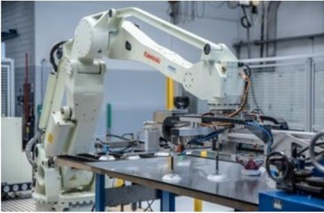
Mit der spezialangefertigten Roboteranlage beschleunigt Metall Service Menziken das Bürsten von Aluminiumblechen. Weiterer Text über ots und [www.presseportal.ch/de/nr/100053189](http://www.presseportal.ch/de/nr/100053189) / Die Verwendung dieses Bildes ist für redaktionelle Zwecke honorarfrei. Veröffentlichung bitte unter Quellenangabe: "obs/Debrunner Acifer AG/zvg"
