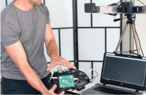
Das Messsystem wurde ursprünglich für Virtual Reality Brillen entwickelt. Forschende der ZHAW School of Engineering haben es so angepasst, dass Nackenbewegungen präzise gemessen werden.
