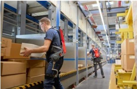
*German Bionic testet neuen intelligenten Kraftanzug "Made in Germany" am IKEA Logistikstandort Dortmund / Das aktive Exoskelett Cray X von German Bionic im Einsatz bei IKEA in Dortmund. (c) German Bionic. Weiterer Text über ots und [www.presseportal.de/nr/126129](http://www.presseportal.de/nr/126129) / Die Verwendung dieses Bildes ist für redaktionelle Zwecke honorarfrei. Veröffentlichung bitte unter Quellenangabe: "obs/GBS German Bionic Systems GmbH/Mert Dürümoglu"*
