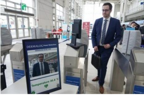
Das DERMALOG-System erfasst die Temperatur jedes Besuchers beim Passieren der Einlasskontrolle und meldet die Messwerte per Bildschirbenachrichtigung an das Kontrollpersonal / Weiterer Text über ots und [www.presseportal.de/nr/8896](http://www.presseportal.de/nr/8896) / Die Verwendung dieses Bildes ist für redaktionelle Zwecke honorarfrei. Veröffentlichung bitte unter Quellenangabe: "obs/DERMALOG Identification Systems GmbH"
