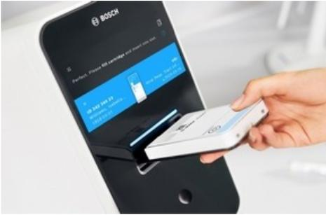
*Die Testdurchführung ist einfach: Die Probe mittels Abstrichtupfer aus Nase oder Rachen entnehmen, ohne weitere Aufbereitung in die Kartusche, die anschließend im Vivalytic-Analyser vollautomatisch prozessiert wird / Weiterer Text über ots und [www.presseportal.de/nr/142767](http://www.presseportal.de/nr/142767) / Die Verwendung dieses Bildes ist für redaktionelle Zwecke honorarfrei. Veröffentlichung bitte unter Quellenangabe: "obs/Bosch Healthcare Solutions GmbH"*
