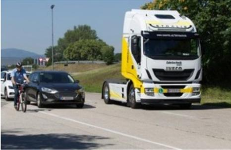
*BILD zu OTS - Der intelligente LKW-Abbiegeassistent Careye Safety Angle von EYYES erkennt Radfahrer in zweiter Spur und warnt den LKW-Fahrer nur dann, wenn beim Rechtsabbiegen eine Kollision tatsächlich errechnet wurde.*
