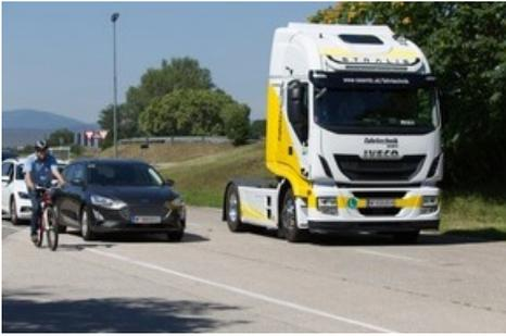
*BILD zu OTS - Der intelligente Abbiegeassistent Careye Safety Angle von EYYES erkennt Radfahrer in zweiter Spur im Toten Winkel und warnt den LKW-Fahrer nur dann, wenn eine Kollisionsgefahr errechnet wurde*
