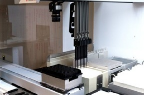
Ein Roboter automatisiert nun die Laborarbeit und kann einige tausend verschiedene PETase-Varianten pro Woche herstellen und vermessen (Bild Hochformat).
