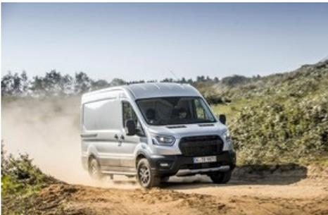
Die Transit Trail-Varianten stehen wahlweise entweder mit mechanischem Quaife-Sperrdifferenzial oder mit Allradantrieb zur Verfügung. / Weiterer Text über ots und [www.presseportal.ch/de/nr/100000451](http://www.presseportal.ch/de/nr/100000451) / Die Verwendung dieses Bildes ist für redaktionelle Zwecke honorarfrei. Veröffentlichung bitte unter Quellenangabe: "obs/Ford Motor Company Switzerland SA"
