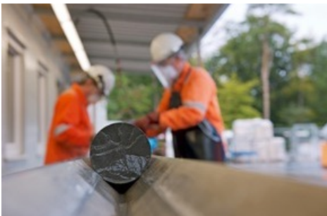
Tiefbohrung TBO Boezberg 2, Nagra, Bohrstelle, Bohrkern Opalinuston, Bohrkernerfassung, Geologisches Standortgebiet Jura Ost; Boezberg, AG, Nagra Tiefbohrung, Bohrstelle, BOZ 2
