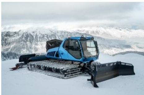
BILD zu OTS - Weltpremiere: Der LEITWOLF h2 MOTION ist das erste Pistenfahrzeug mit Wasserstoff-Technologie
