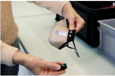
Die Maske besteht aus einem mehrlagigen Textil, Elektroden und einer kleinen Batterie. (Foto: ZHAW / Hannes Heinzer)
