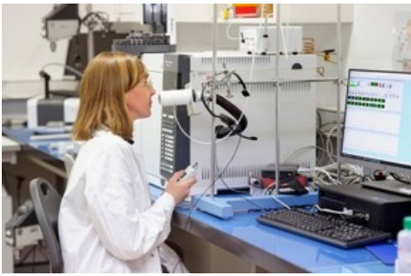
Zur Identifikation der Aromen nutzte Aromaforscherin Irene Chetschik unter anderem die Methode der Gaschromatographie-Olfaktometrie.
