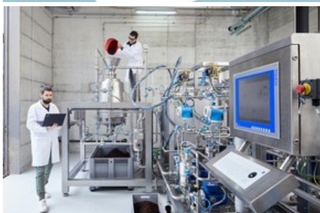
Mit der Extraktionsanlage für Pflanzenstoffe lassen sich aus Sägerei-Reststoffen Inhalte gewinnen, die in der Bauwirtschaft erdölbasierte Produkte ersetzen. Bild: Berner Fachhochschule
