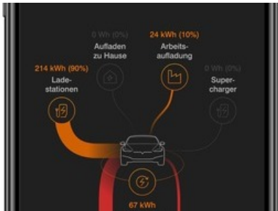
Der j+ pilot ermöglicht eine genaue Auswertung der Energiezufuhr und des effektiven Verbrauchs (inkl. Vampire Drain). / Juice Technology AG
