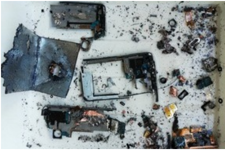
Mittels elektrodynamischer Fragmentierung lassen sich gemischte Wertstoffe in ihre Komponenten auftrennen. Bild: Selfrag AG
