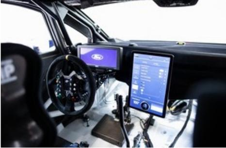
Electric SuperVan verfügt über Ford SYNC 4-Konnektivität, spezielle Fahrprogramme und die Möglichkeit zur Bremsenergie-Rückgewinnung / Weiterer Text über ots und [www.presseportal.ch/de/nr/100000451](http://www.presseportal.ch/de/nr/100000451) / Die Verwendung dieses Bildes ist für redaktionelle Zwecke honorarfrei. Veröffentlichung bitte unter Quellenangabe: "obs/Ford Motor Company Switzerland SA"
