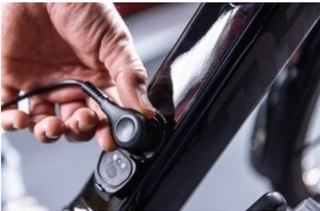
*Diamant 365 - Über den Ladeanschluss wird auch der optionale Range Extender mit der Hauptbatterie verbunden / Weiterer Text über ots und [www.presseportal.de/nr/162550](http://www.presseportal.de/nr/162550) / Die Verwendung dieses Bildes ist für redaktionelle Zwecke unter Beachtung ggf. genannter Nutzungsbedingungen honorarfrei. Veröffentlichung bitte mit Bildrechte-Hinweis.*
