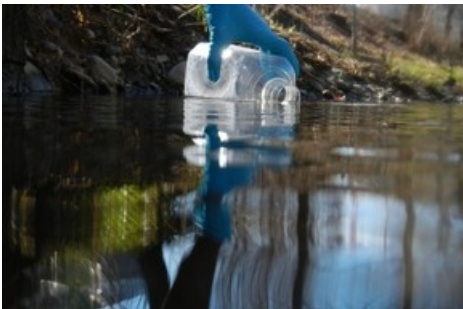
Entnahme einer Wasserprobe zur Analyse von Umwelt-DNA Foto: Elvira Mächler, EAWAG
