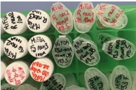
Wasserproben im Labor zur Analyse der Umwelt-DNA Foto: Jeanine Bratschen, EAWAG
