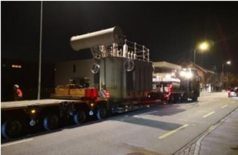
*Vergangene Woche wurde an das SAK Unterwerk Widnau ein neuer 110/20 kV Transformator geliefert (Bild: SAK).*
