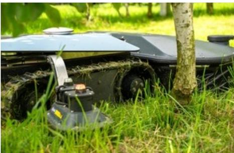
Neue autonome Technik im Test: Selbstfahrender Mulchroboter Scarabaeus im Einsatz auf dem Obstbau-Versuchsbetrieb in Güttingen TG. Quelle: Brüggli Industries
