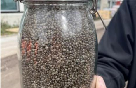
*Mittels Recyclingprozess wird hochwertiges Polystyrol-Granulat gewonnen, das für neue EPS-Dämmstoffe eingesetzt werden kann. / Weiterer Text über ots und [www.presseportal.de/nr/112060](http://www.presseportal.de/nr/112060) / Die Verwendung dieses Bildes für redaktionelle Zwecke ist unter Beachtung aller mitgeteilten Nutzungsbedingungen zulässig und dann auch honorarfrei. Veröffentlichung ausschließlich mit Bildrechte-Hinweis.*
