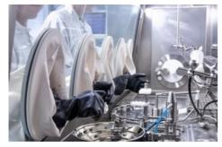
BILD zu OTS - Zu den Kapazitäten von Biomay gehört ein Isolator mit sieben Handschuhen, der mit einer automatisierten Verarbeitungslinie für aseptische Abfüllung, Verschließen und Crimpen von Fläschchen ausgestattet ist und in erster Linie klinische Prüfpräparate (IMPs) herstellt.
