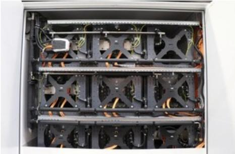
Lithium-Ionen-Batteriespeicher im Container des Mega Chargers / © Designwerk Technologies AG
