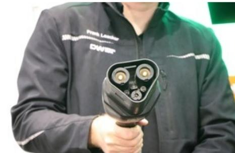
Megawatt Charging MCS Stecker der Designwerk Technologies AG / © Designwerk Technologies AG
