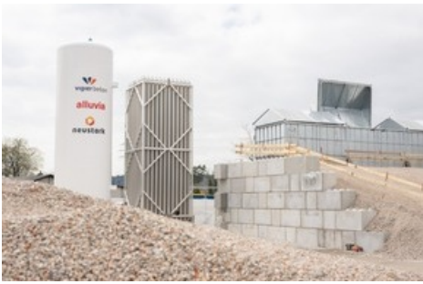
Die Kernkompetenz von neustark: Die permanente Speicherung von CO2 in Abbruchbeton. Hier die Grossanlage in Biberist, Schweiz
