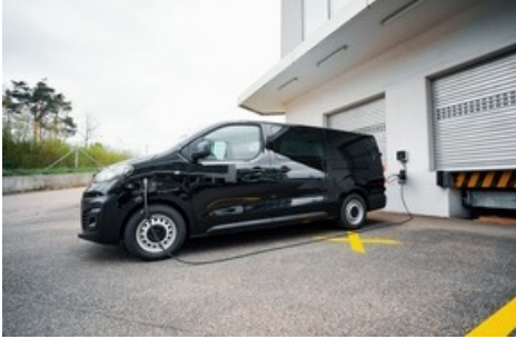
Thermo- und Induktionsschutz ermöglichen das Laden auch bei teilweise aufgewickeltem Kabel. / Juice Technology AG
