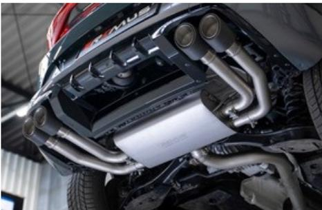
BILD zu OTS - REMUS Abgasanlage für Cupra Formentor
