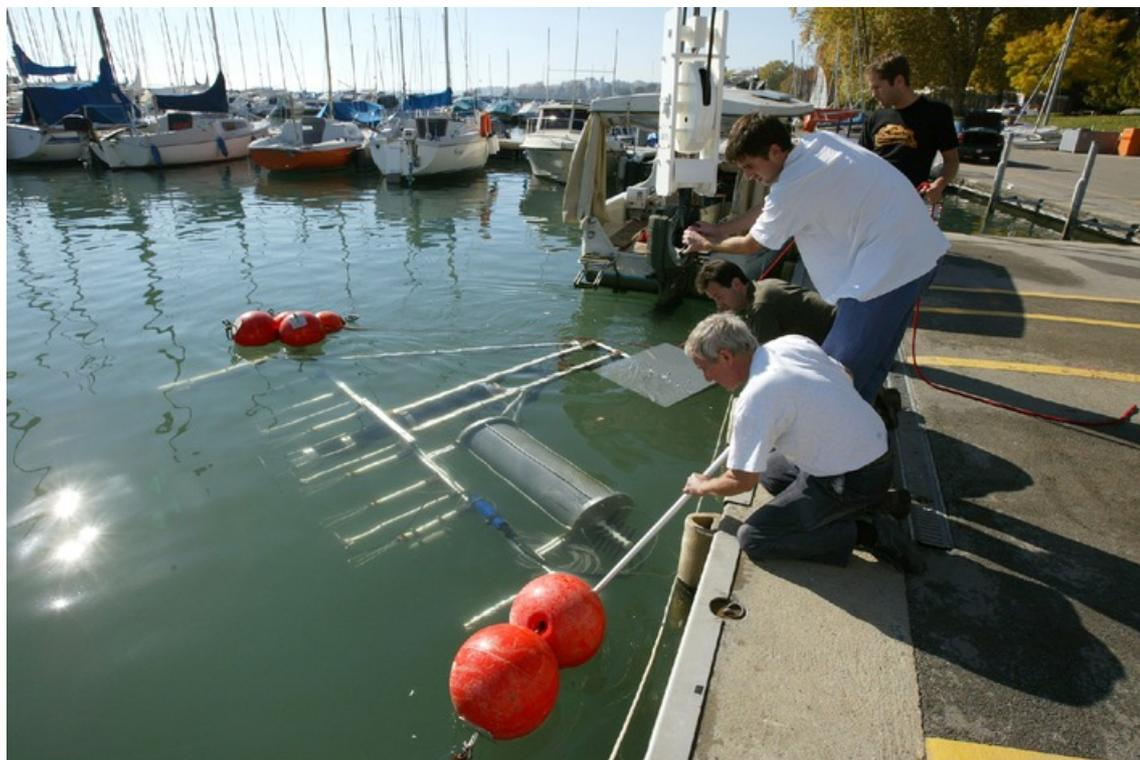
Forschende der ETH Lausanne ziehen Sensoren aus dem Genfersee, mit denen sie die Bewegung und die Vermischung der Wasserschichten gemessen haben..
