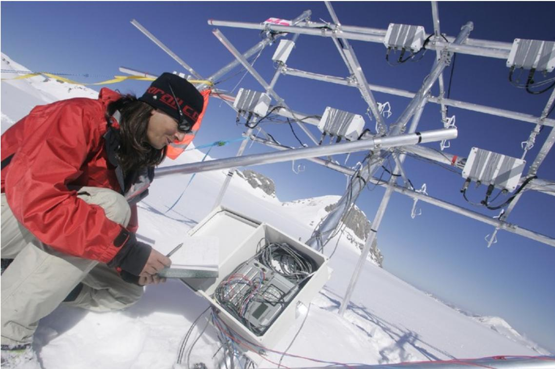
Ein Forscher der ETH Lausanne installiert Schall-Windmesser auf dem Gletscher der Plaine Morte. Damit lassen sich die Luftturbulenzen über der Schneedecke mit sehr grosser räumlicher und zeitlicher Auflösung messen.
