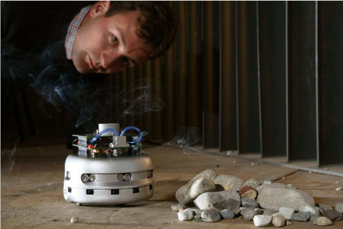
Ein Windkanal ermöglicht Thomas Lochmatter, die Versuche an den Robotern mit Geruchsdetektor beliebig oft zu wiederholen.
