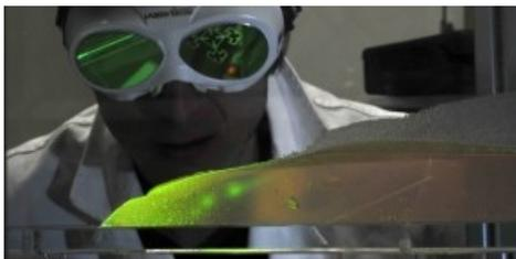
*Bildlegende: Durchführung eines Staudammbruch-Experiments: Ein Laserstrahl beleuchtet den Frontbereich des Abflusses. Mithilfe von Kameras verfolgen die Forschenden die Bewegungen bestimmter Partikel. © Laboratorium für Umwelthydraulik, EPFL/SNF*
