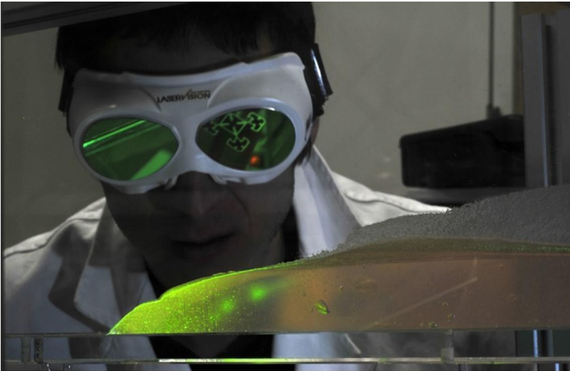
Durchführung eines Staudammbruch-Experiments: Ein Laserstrahl beleuchtet den Frontbereich des Abflusses. Mithilfe von Kameras verfolgen die Forschenden die Bewegungen bestimmter Partikel.
