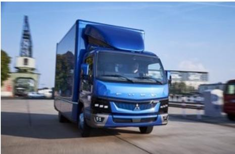
*Fuso eCANTER, Exterior, mid-blue metallic, generator: DC 12 V 250 Amp, HV battery: 70 kWh, Engine power: 185 kW, curb weight: 2860 kg, payload: up to 4600 kg, seating capacity:3; Texte complémentaire par ots et sur [www.presseportal.ch/fr/nr/100001544](http://www.presseportal.ch/fr/nr/100001544) / L'utilisation de cette image est pour des buts rédactionnels gratuite. Publication sous indication de source: "obs/Mercedes-Benz Schweiz AG/Daimler AG"*
