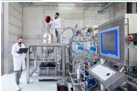
L'installation d'extraction des substances végétales permet de produire des substances à partir de matières résiduelles de sciage, pour remplacer les produits à base de pétrole dans le secteur du bâtiment. Image: Haute école spécialisée bernoise
