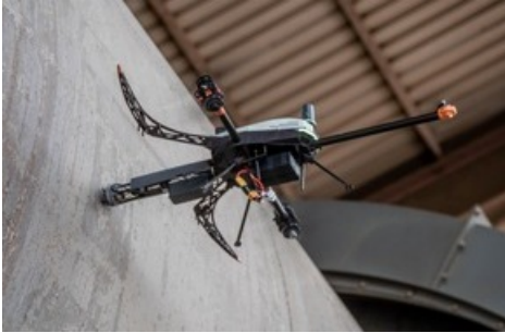
Les drones sont même capables d'effectuer des mesures sur des surfaces chaudes et en présence d'un important encrassement. ©Voliro
