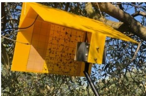
Prototype d'un nouveau type de piège pour les mouches de l'olive. Une fois que le piège a capturé les insectes, il les photographie et envoie automatiquement des images haute résolution à un centre de contrôle. Cela facilite le suivi des insectes nuisibles et permet ainsi une lutte plus efficace.
