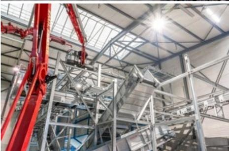
*Les bouteilles à boissons en PET sont acheminées vers les stations de tri par un réseau dense de convoyeurs. À la fin du processus, le matériau présente une pureté de plus de 99 pour cent.*
